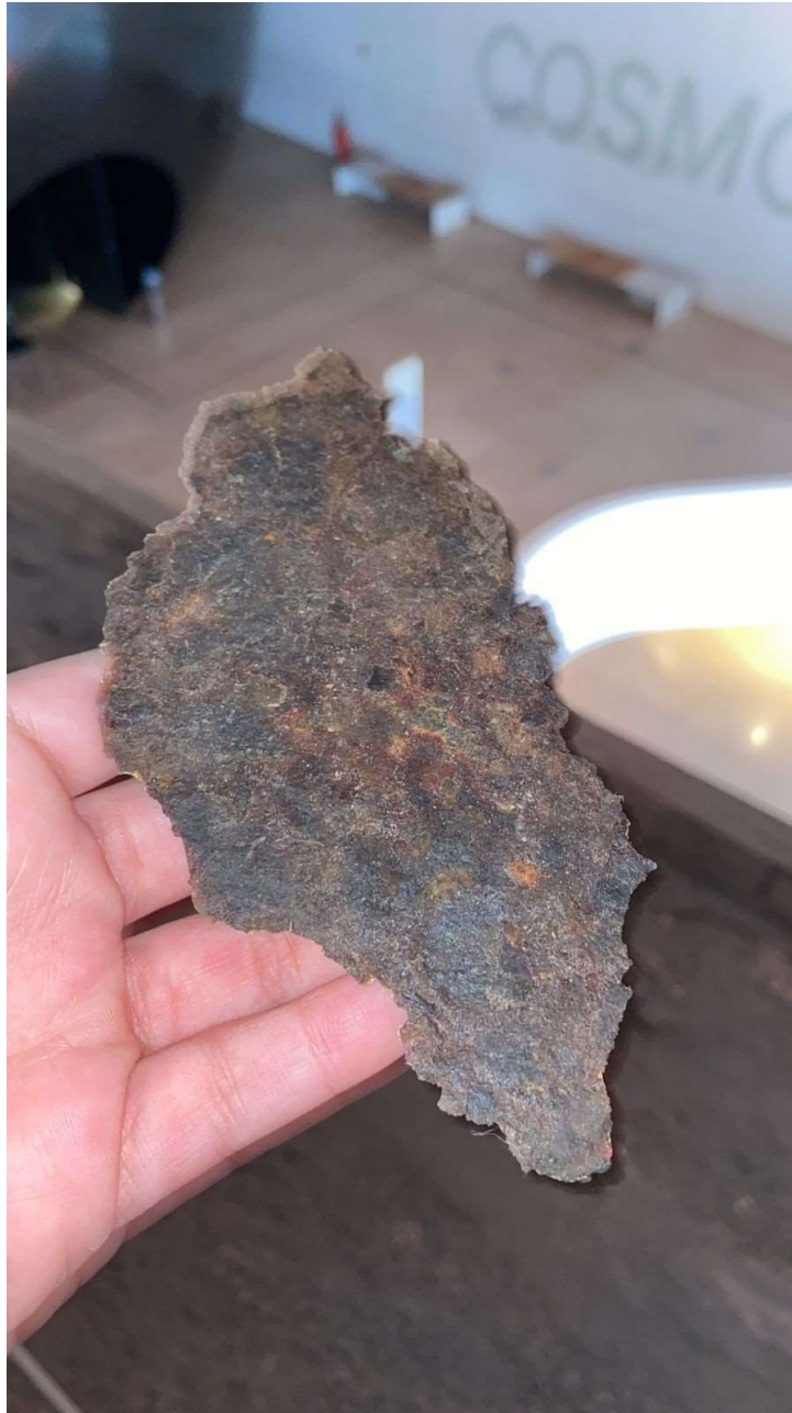
FOTO 73 – DESCOLAMENTO DE CHAPA DE AÇO COM CORROSÃO AVANÇADA
